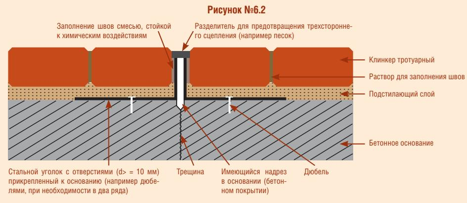
Стальной уголок должен иметь отверстия, длина горизонтальной полки должна составлять не менее трехкратного значения высоты кирпича, но не менее 200 мм. Длину вертикальной стенки уголка выбирают таким образом, чтобы в установленном состоянии она закрывала примерно 2/3 толщины клинкера. Для предотвращения возможного изменения цвета светлого клинкерного покрытия из-за образования ржавчины, стальной уголок должен иметь достаточную антикоррозийную защиту.
